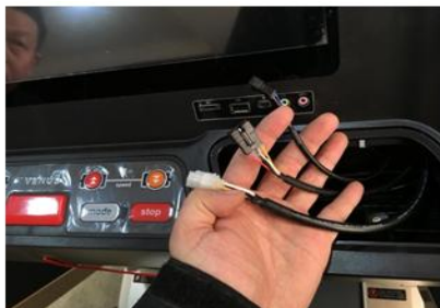
(Рис. 3) правый сигнальный кабель, кабель подсветки, кабель питания
