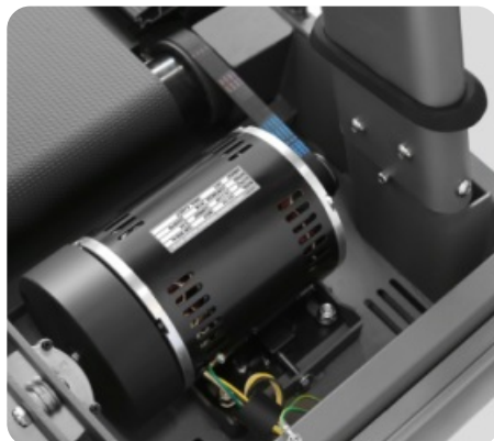
ДВИГАТЕЛЬ LEESON МОЩНОСТЬЮ 3,5 Л.С. (AC)
