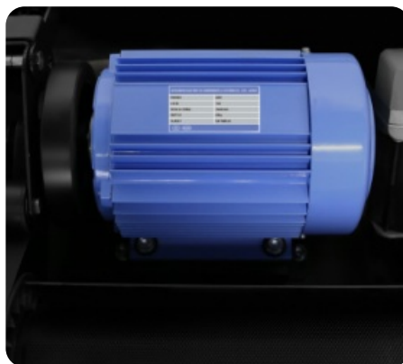
ДВИГАТЕЛЬ MITSUBISHI МОЩНОСТЬЮ 4,0 Л.С. (AC)
